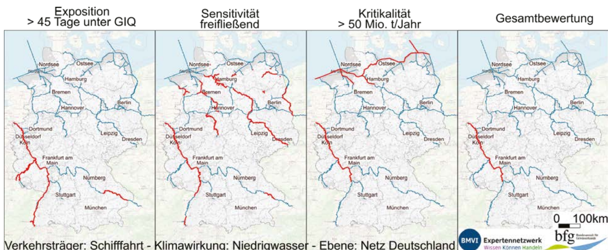
Abbildung 6: Ansatz einer integrierten Klimawirkungsanalyse für die Bundeswasserstraßen am Beispiel der Wirkungskette „Tiefenengpass, Abladebeschränkung bei Niedrigwasser“ unter Annahme des Weiter-wie-bisher-Szenarios in der fernen Zukunft (2071-2100). Rot markiert sind jeweils die Bereiche des Wasserstraßennetzes, die in den Teilanalysen zur Exposition (Anzahl Tage unter einem Niedrigwasserschwelwert, links), Sensitivität (freifließende Strecken, mitte links) und Kritikalität (Güteraufkommen; mitte rechts) sowie der Gesamtbewertung (rechts) als „besonders betroffen“ klassifiziert wurden. Das entsprechende Klassifizierungskriterium ist jeweils als Abbildungsüberschrift angegeben. GIQ: Gleichwertiger Abfluss.
