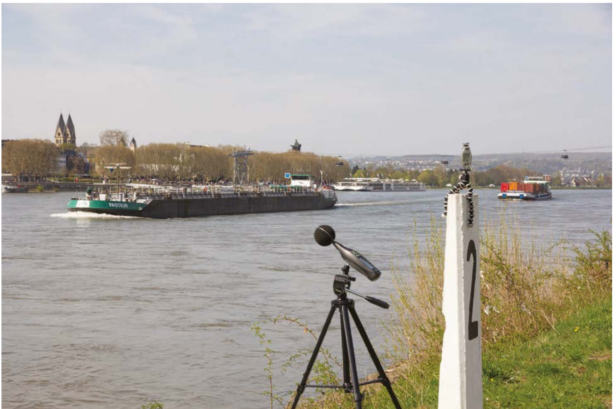
Abbildung 13: Lärmmessung am Rhein in Koblenz (Bild: Bundesanstalt für Gewässerkunde).
