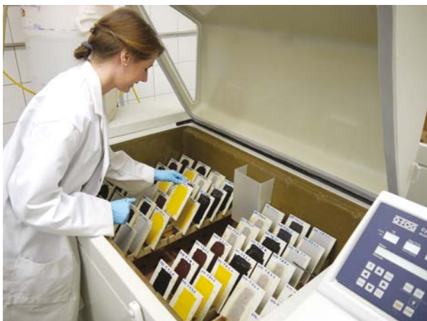
Abbildung 18: Smart Repair. Anhand von Versuchsprobenplatten wird durch kontinuierlichen Salzsprühnebel eine beschleunigte Alterung mit erhöhtem Korrosionsdruck für viele unterschiedliche Materialien und Korrosionsschutzbeschichtungen simuliert. Anhand dieser umfangreichen Wissensbasis kann die ideale Reparaturmaßnahme schnell ermittelt und so die Instandsetzung von Stahlbauteilen vereinfacht und beschleunigt werden (Bilder: Bundesanstalt für Wasserbau).
